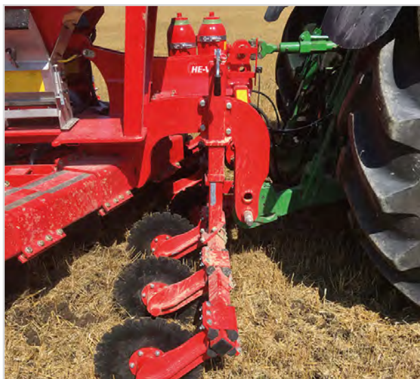
Bâti de Disque avec les disques Ø470mm montés
