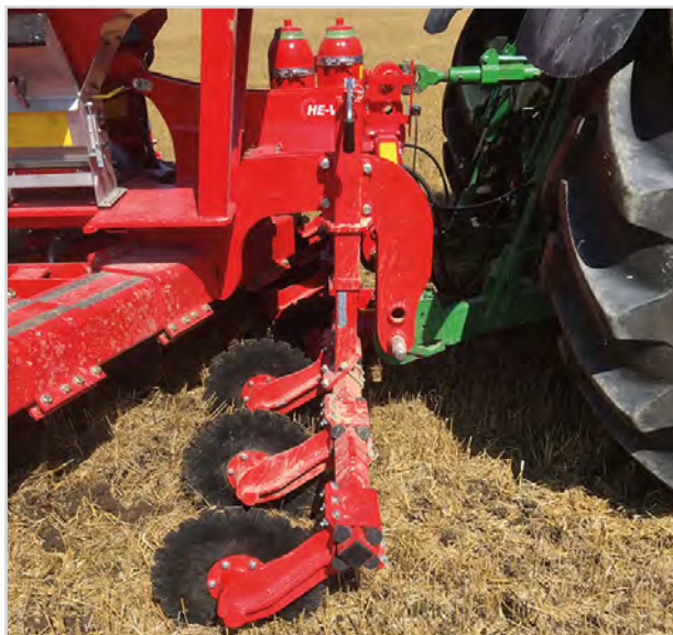
Sub-Tiller mit Scheibensektion (Rahmen mit Scheiben Ø470 mm)
