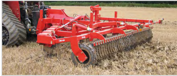
5,00 m Sub-Tiller mit V-Profil-Walze und hydr. Steinsicherung
