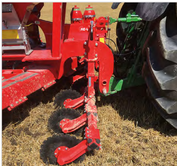
Ramme for rulleskær med rulleskær Ø470 mm.
