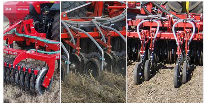
Skiveskærs-såning (12 cm ml./skiveskær) med 75mm brede dybdehjul/pakkerhjul. Placeret i 2 rækker pr. tand. En række på hver side af grubbesporet efter pakkervalse.
