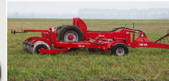
Die gezogenen Sub-Tiller sind für größere Schlepper mit bis zu 600 PS zugelassen.
