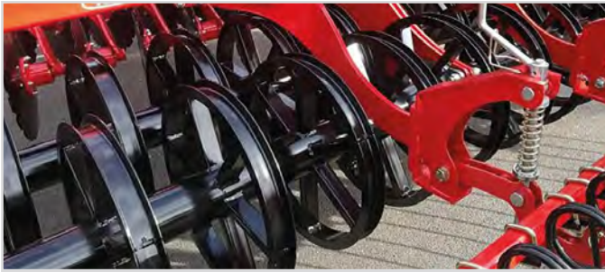
Ø600 mm U-Profile Roller Twin.
