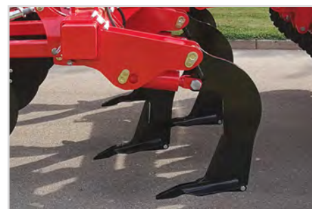
Zinken-Design Combi-Tiller MKII und Combi-Disc.
