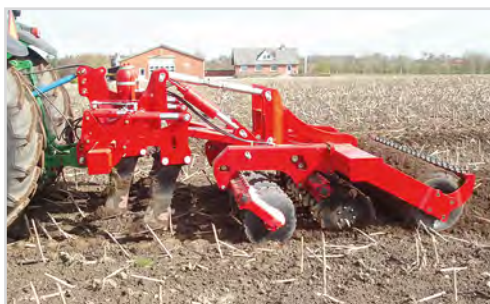
Combi-Disc mit angehobenen Zinken frei – es arbeitet ausschließlich der Disc-Roller Contour.
