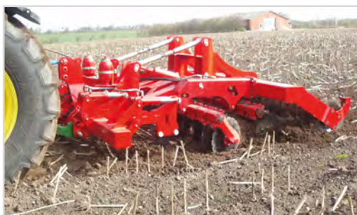
Combi-Disc mit den Zinken in max. Arbeitstiefe, gewährleistet Tiefenlockern, Kultivierung und Rückverfestigung.
