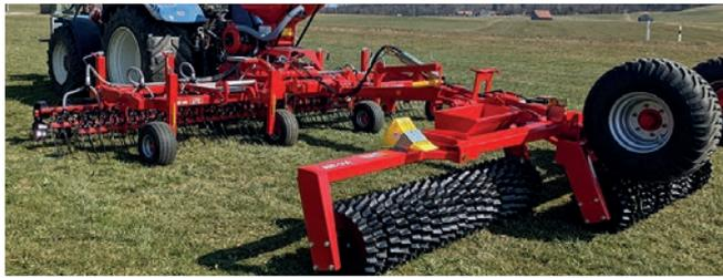
Durch den Koppelbock ist es möglich, den Striegel zusammen mit einer Walze einzusetzen. Hierdurch wird das Striegeln, die Nachsaat und das Anwalzen in einem Arbeitsgang erledigt.
