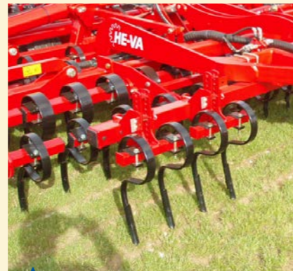
Spurlockersatz mit 2x4 Zinken vor dem Spring-Board und robuster Frontegge.
