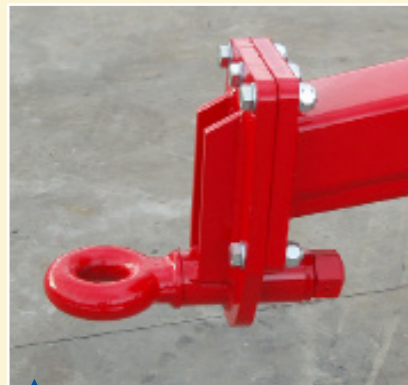
Euro-Tiller ist Standard mit drehbarer Zugöse versehen.
