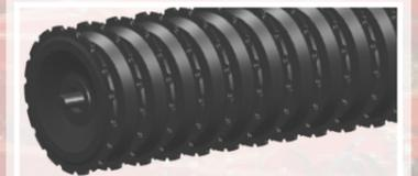
Le rouleau V-profil Ø600 est un bon émietteur qui rappuit en profondeur en laissant un aspect très légèrement billonné ce qui contribue à ce que le sol conserve une bonne capillarité. Les anneaux V-profil sont dentelés, en acier embouti avec un épaulement contrôlant la pénétration. Ces anneaux brisent les mottes résiduelles et retassent les sols lourds, et ils rappuient efficacement sur sols légers. Les décrotoirs entre les anneaux sont réglables et assurent un excellent décaissage.
