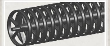
La conception du rouleau U-profil est réalisée de manière à ce que le rouleau soit rempli de terre durant le travail afin d'accomplir un compactage du sol optimal et d'apporter une structure naturelle sans lissage à la surface du sol.
