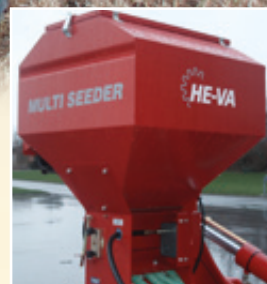
Multi-Seeder – precīzās darbības sējmašīna – ir speciāli pielāgota precīzai rapša sēšanai.
