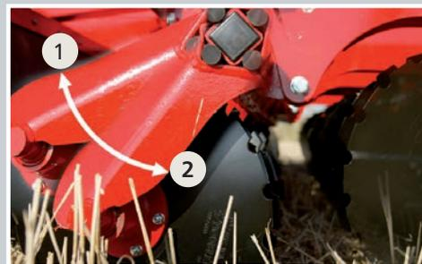
1 Lors du travail superficiel, le disque est pratiquement perpendiculaire au sol, il repousse latéralement le sol et enlève toute sa surface. Briser le sol meuble plutôt que de le « ramasser » signifie qu'il n'y a pas de lissage, ce qui créerait une semelle.
