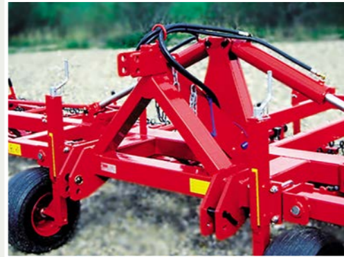
Das Kopplungssystem bei 9,00 low, 12,00 und 15,00 m Modellen
