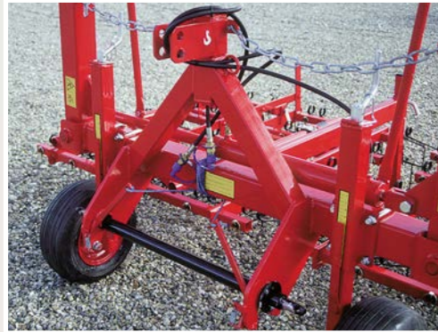
Das Kopplungssystem bei 6,00, 7,50 und 9,00 m Modellen.
