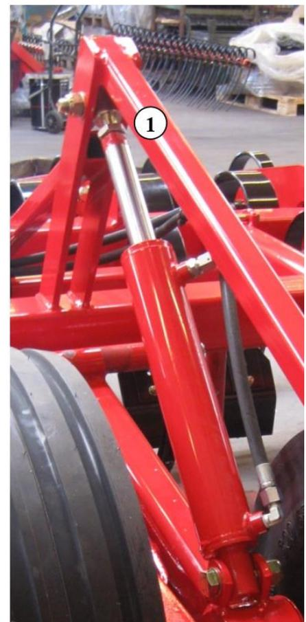
vorgenommen worden. Der Boden sollte für die vorlaufenden Einebnungszinken über die gesamte Arbeitsbreite bearbeitet sein. Der Master-Zylinder sollte **nie** mehr als 30 mm ausgefahren werden (50 mm bei den Slave-Zylindern). Stellen Sie sicher, dass alle Kronenmuttern angezogen werden!
