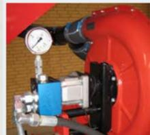
Débit d'huile exigé de 10 à 17 l/min. Une soupape de sécurité protège le moteur hydraulique des surcharges.
