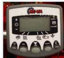
Les indications de débit enregistrées dans le moniteur Auto-Controller peuvent être corrigées à volonté au travail. Le Multi-Seeder est calibré en activant l'interrupteur sur l'unité de dosage. En plus des fonctions de surveillance de la turbine et de la trémie, l'Auto-Controller à l'aide de la fonction "pre-start" permet de réduire les pertes de semences dans les bouts et coins de champs. L'interrupteur de semis standard est monté sur la barre d'attelage supérieure.
