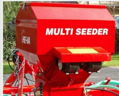
Le Multi-Seeder modèle EL est avec double turbine électrique 12v.
