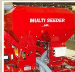
Le Multi-Seeder Twin a deux compartiments à 100 litres, et les débits des 2 unités de dosage peuvent être réglés indépendamment. Ainsi, le Multi-Seeder Twin est idéal pour le semis de colza avec anti-limace.
