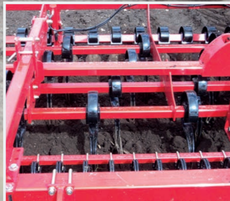
65x12mm规格的耙齿，15cm行距适用于需要保留土壤表面结构的轻整地作业。这款耙齿可以很好地整理有轻度残茬的土壤，180x6mm规格的鹅脚形齿尖能确保彻底切断残茬。
