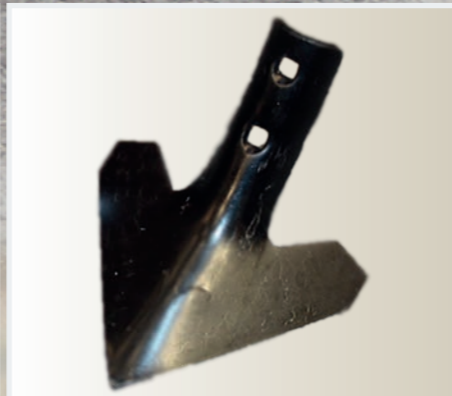
65x12mm规格的耙齿，15cm行距适用于需要保留土壤表面结构的轻整地作业。这款耙齿可以很好地整理有轻度残茬的土壤，180x6mm规格的鹅脚形齿尖能确保彻底切断残茬。
