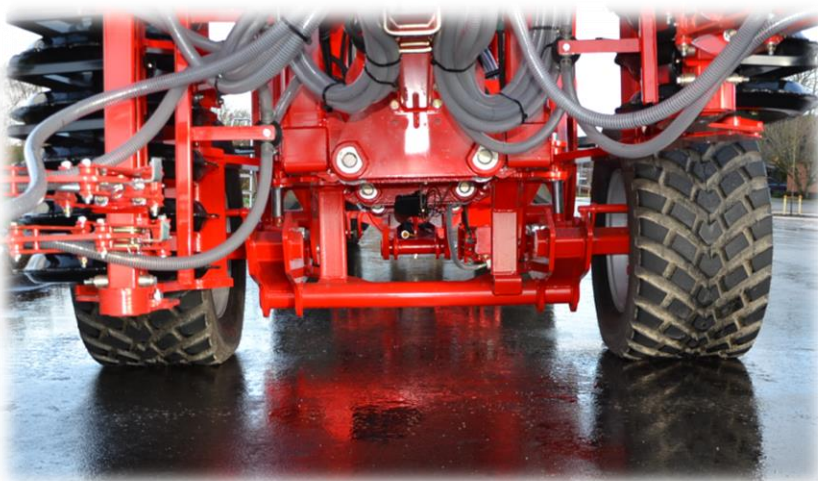
Foto 2. Transportstützen in Transportposition auf der Radaufhängung
