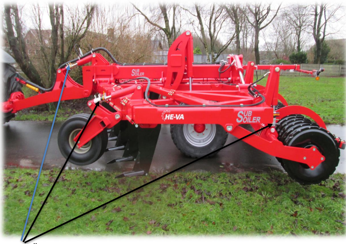
Foto 7: Über Verstellsegmente wird die Arbeitstiefe eingestellt.
