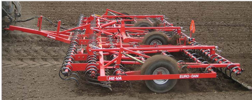
8,00 m. Euro-Dan Eco m/svær forharve, Spring-Board fjedertandsplanerplanke, Spring-Board efterharve og langfinger-efterharve
