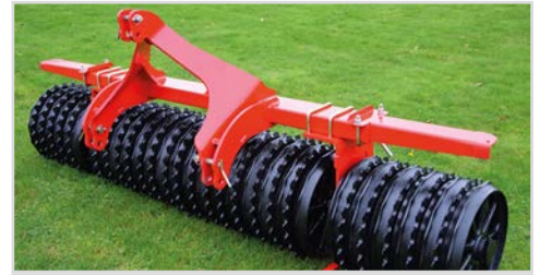
Front-Roller med fastmonteret trepunktsophæng - ikke selvstyrende
