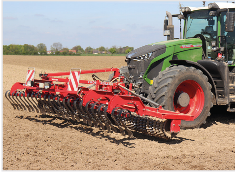
3,00 m Front-Roller Twin m/Ø550/550 mm Stjärnring.
