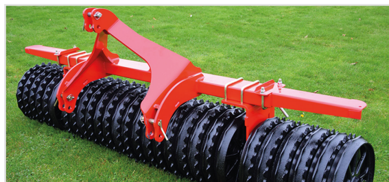
Front-Roller med ett fast trepunktsfäste - inte självstyrande
