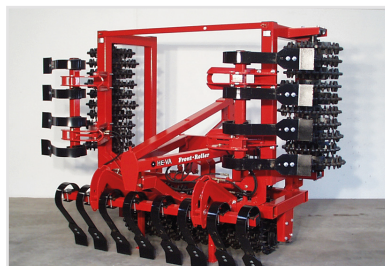
4,00 m Front-Roller m/Cross-kill, hydr. ihopfälln och Spring-Board.
