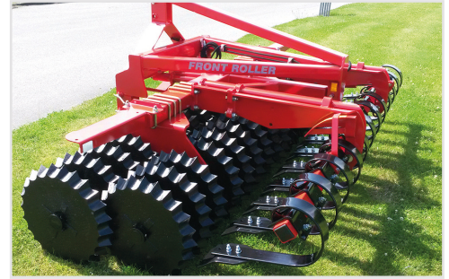
3,00 m Front-Roller Twin m/Ø550/550 mm Stjärnring.
