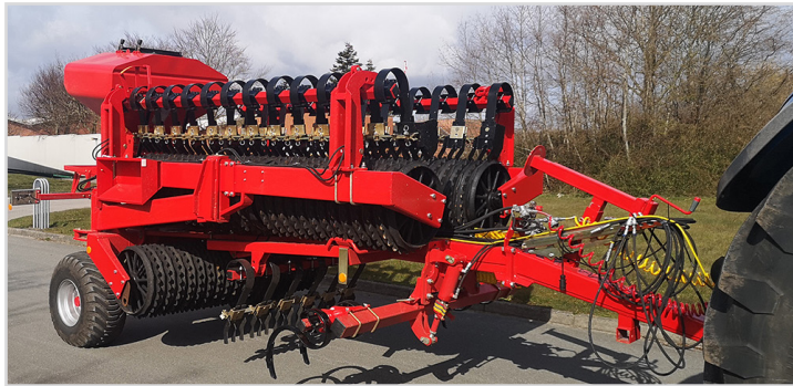
Tip-Roller replié avec Multi-Seeder, Spring-Board et Efface traces
