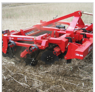
Combi-Tiller MKI m/Dreipunktaufnahme f/Kombination m/Disc-Roller Contour (3-Punkte-Modelle). Inkl. 1 Satz Hydraulikverlängerungsschläuche, Verlängerung f/Beleuchtung und Spezialstützbeine f/Disc-Roller Contour.
