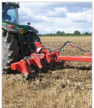
Combi-Tiller MKI m/Dreipunktaufnahme u. Zugmaul f/Kombination m/aufgehängten und aufgesattelten Geräten wie z.B. "Dammformer" f/Kartoffeln oder aufgesattelte Drillmaschinen.
