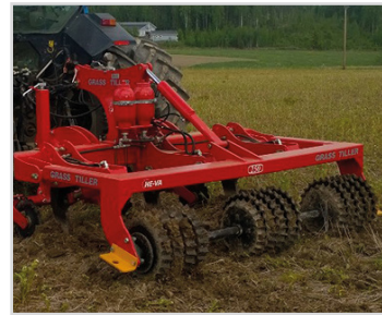
2,50 m Grass-Tiller m/hydr. auto.udløser og stjernevalse synkron
