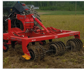
2,50 m m/hydr. stenutlösning och Stjärnvals synkron.
