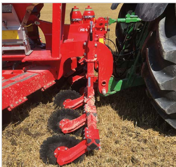
Ramme for rulleskær med rulleskær Ø470 mm.
