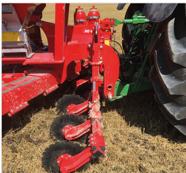
Ram för rullskär med rullskär Ø470 mm.
