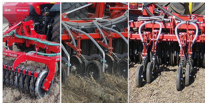
Skivskärssåning (12 cm ml./skivskär) m/ 75 mm breda djuphållningshjul / packhjul. Placerat i 2 rader per pinne. En rad på var sida om avluckringsytan efter packvalsen
