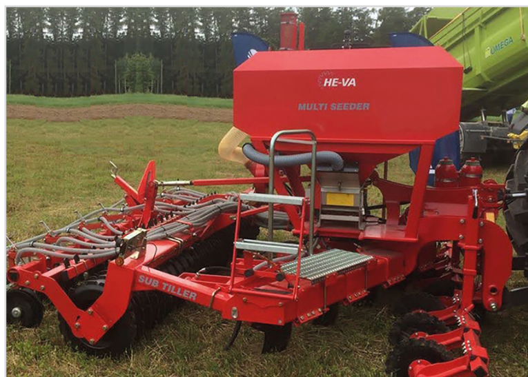
Sub-Tiller avec semoir Multi-Seeder 1.150 L
