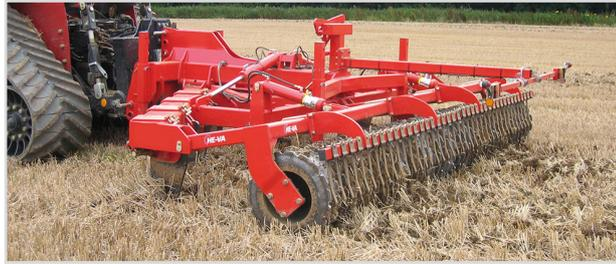
5,00 m Sub-Tiller mit V-Profil-Walze und hydr. Steinsicherung
