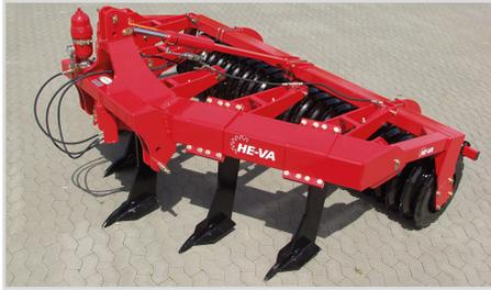
3,00 m Modell, 5 Zinken, m/V-Profilwalze und hydr. Steinsicherung.
