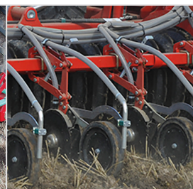
Skivskärssåning med 75 mm breda djuphållningshjul / packhjul. Placerat i 1 rad per pinne efter packvalsen.
