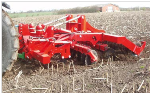
Combi-Disc med tænderne i fuld arbejdsdybde. Dermed opnås grubning, kultivering og pakning.
