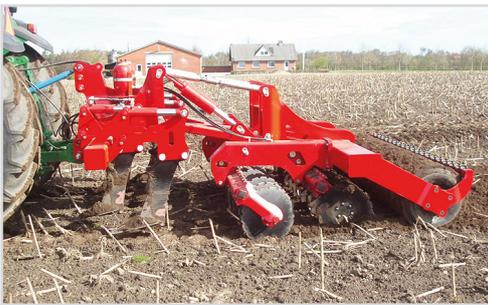
Combi-Disc mit angehobenen Zinken frei – es arbeitet ausschließlich der Disc-Roller Contour.
