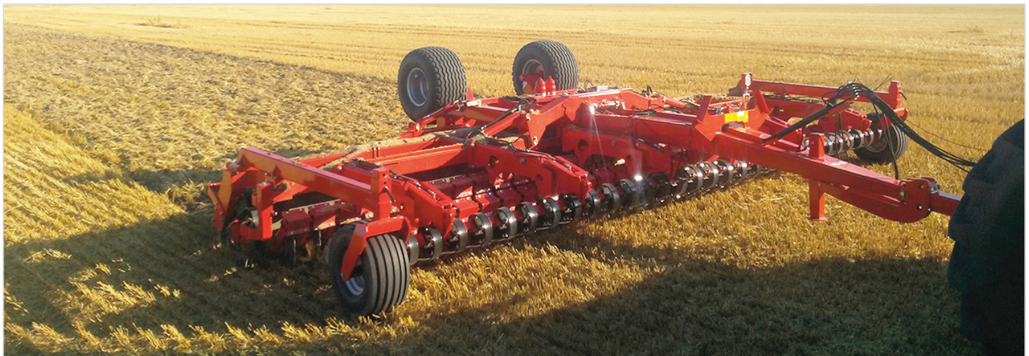
6,50 m Disc-Roller m/V-Profilvalse, materialedæmperskærm, drejbart støtte-/dybde-hjul og svingbart træk
