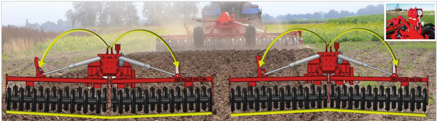
Standardudstyr på 2- og 3-leds modeller: HE-VA SAT-System: Hydraulisk justerbar vægtoverføringssystem, der sikrer ens vægtoverføring i hele arbejdsbredden og samtidig bevirker at vingesektionerne følger terrænet.
