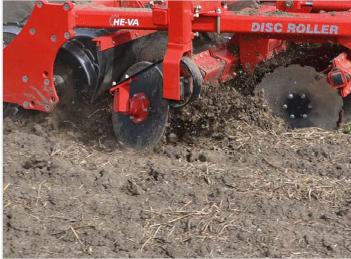
Standardudstyr på alle modeller: Justerbar kanttallerken for jævn overgang mellem hvert træk, højre side.
