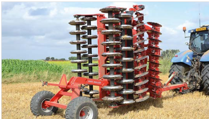
5,50 m Disc-Roller Contour m/Twin V-Profilvalse og materialedæmperskærm.
