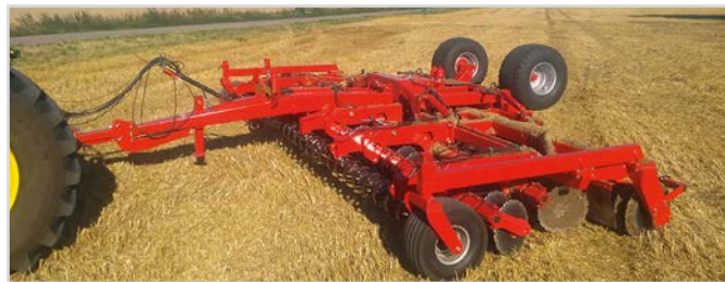
8,00 m Disc-Roller Contour med V-Profilvalse, drejbare støtte/dybdehjul.
