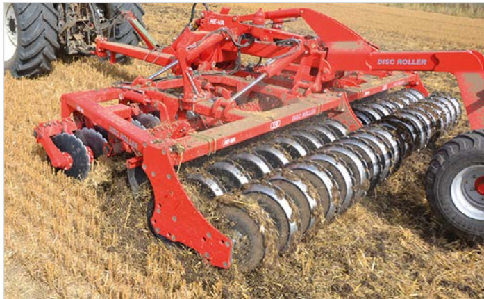
5,50 m Disc-Roller Contour m/Twin V-Profilvalse og materialedæmperskærm.
