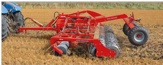
5,50 m Disc-Roller Contour med Twin V-Profilvalse og materialedæmperskærm.
