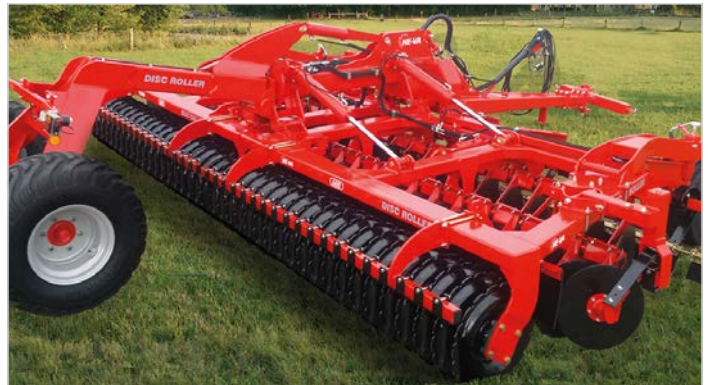
6,50 m Disc-Roller m/V-Profilvalse, materialedæmperskærm, drejbart støtte-/dybde-hjul og svingbart træk
