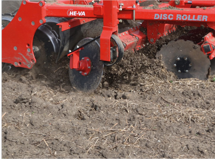
Standard sur tous modèles: Disques de bordures réglable, côté droit.
