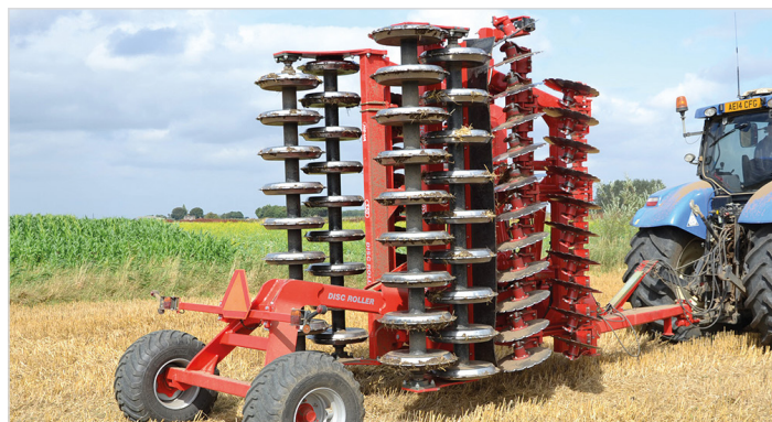
Disc-Roller Contour 5,5 m avec rouleau Twin V-Profil et tablier caoutchouc
